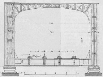
Abb. 9. Stirnansicht des Trägers von 75,25 m Spannweite.
