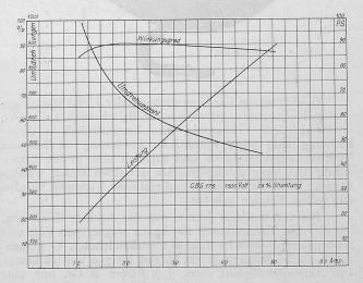
Abb. 6. Charakteristische Kurven bei Shuntung von 280/0.
