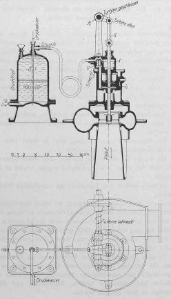
Abb. 20. Automatischer Freilauf. — Masstab I: 20. Von Theodor Bell & Cie. A.-G. in Kriens.
