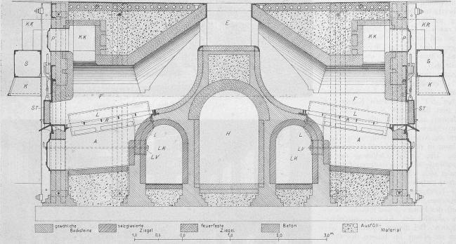
Abb. 9. Der «Horsfall-Destructor». — Querschnitt. — Masstab 1:50.
