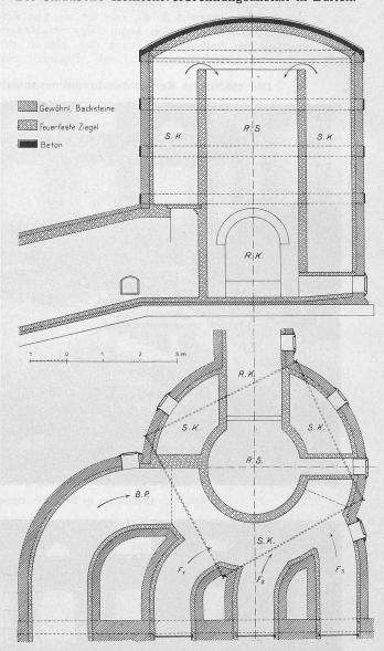
Abb. 14. Der Staubfänger. — Masstab 1: 100. Legende: BP Bye-Pass, F1 F2 F3 Fuchs, SK Staubkammern, RS Rauchschacht, RK Rauchkanal.
