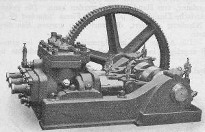
Abb. 13. Oeldruckpumpe von Escher Wyss & Cie.
