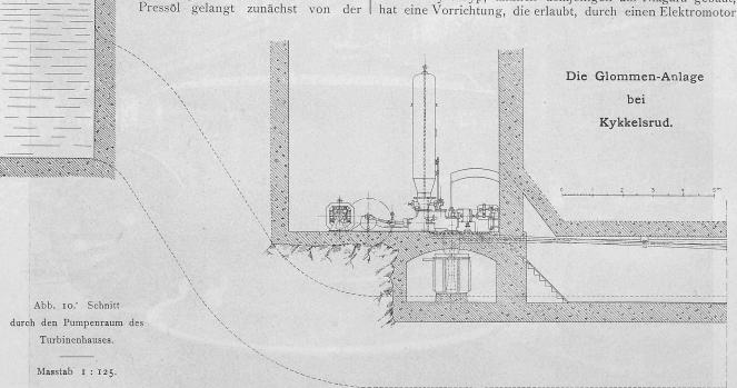
Pumpe und deren Windkessel in das Regulierventil, das an den Ständer des automatischen Regulators angebaut ist; letzterer befindet sich bequem zugänglich auf dem Dynamoboden. Von dort aus führen es zwei kleine Rohrleitungen zu den genannten Zylindern. Durch einen oberhalb dieser Zylinder an den Kolbenstangen angebrachten, kräftigen Ring werden die drei Kolbenstangen auch oben verbunden, sodass ein Zwängen ausgeschlosssen ist.
