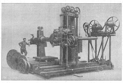
Horizontal-Bohr- und Fräsmaschine mit elektrischem Antrieb.
