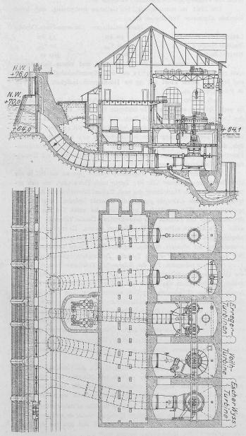
Abb. 9. Das Maschinenhaus der Glommen-Anlage. Querschnitt bei der Escher Wyss-Turbine und Grundriss. — 1:500.
