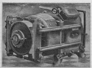
Abb. 3. Bremseinrichtung für elektr. Aufzugsmotoren von L. Scott & Cie.
