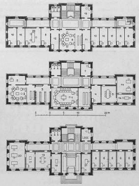
Grundrisse vom Erdgeschoss, I. und II. Obergeschoss. — 1:600.
