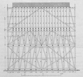
Abb. 9. Querschnitt durch das Lehrgerüst. — Masstab 1:250.
