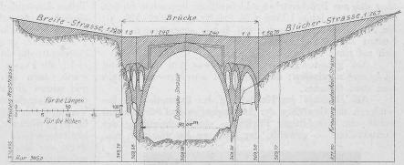
Abb. 2. Längenprofil. — Masstab I: 3000 für die Längen, I: 600 für die Höhen.
