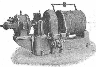
mit automatisch-elektrischer Druckknopfsteuerung
