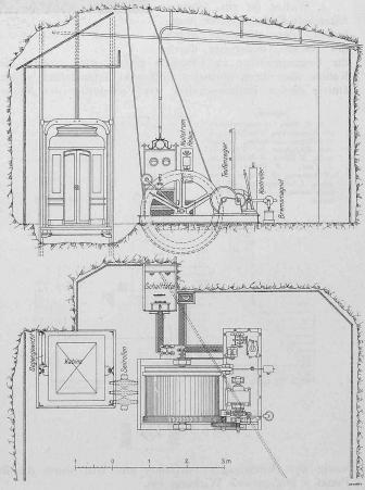
Abb. 4. Die Maschinenkammer mit der Aufzugswinden-Einrichtung. Masstab I: 100. — Gebaut von C. Wist & Cie. in Seebach
