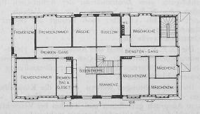
Abb. 6. Grundriss vom Dachgeschoss. — Masstab 1:400.
