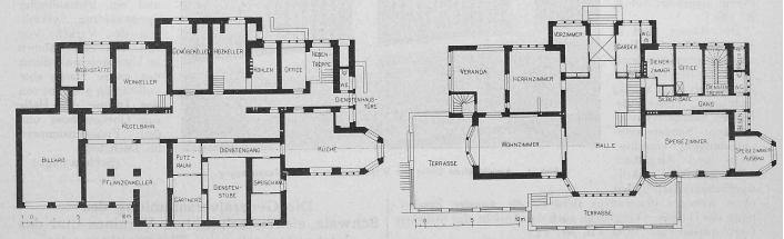
Abb. 3 und 4. Grundrisse vom Untergeschoss und Erdgeschoss. — Masstab 1:400.
