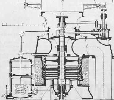
Abb. 5. Vertikale «Union»-Dampfturbine. — Masstab 1:25.
