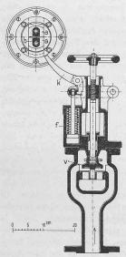
Abb. 6. Sicherheitsregulator mit Schnellschlussventil. Masstab I: Io.
