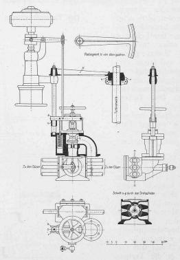
Abb. 4. Schema von Steuerung und Sicherheitsvorrichtung. — 1:25.
