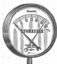
mit Zeigerskala, und mit graphischer Darstellung zur Orientierung und Kontrolle der Zugstärke in Kanälen, Röhren, Schächten, Feuerzügen etc.
