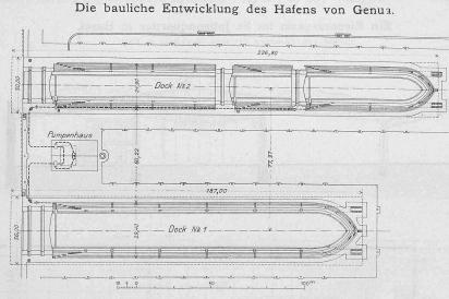
Abb. 6. Lageplan der Trockendocks. — Masstab 1:2000.
