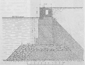
Abb. 5. Querschnitt einer Quaimauer im innern Hafen. — 1:250.
