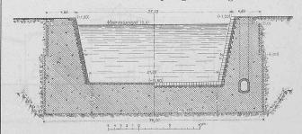
Abb. 8. Querschnitte der Eintrittskammer des Docks Nr. 1. — 1:500
