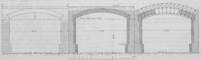
Abb. 11. Quaimauer der Calata delle Grazie. — Ansicht und Längsschnitte. — Masstab 1:250.
