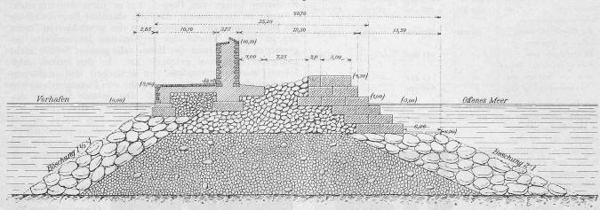
Abb. 4. Ursprünglicher Querschnitt des von 1877 bis 1888 erbauten Molo Galliera. — Masstab I: 500.
