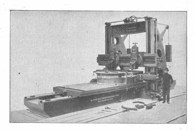
Hobelmaschine von 2500 mm Durchgang.
