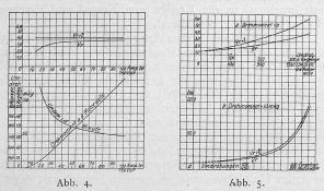
Vr= Verluste in den Zahnrädern und Achsenlagern an den Motoren, Vr+t= Verluste in den Zahnrädern und Achsenlagern an den Motoren und an der Transmission.
