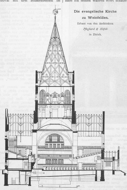
Abb. 12. Schnitt durch Haupteingang, Turm und Orgelempore. — Masstab 1: 300.
