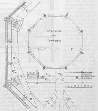
Abb. 13. Details vom Turmhelm. — Masstab 1:150 und 1:30.
