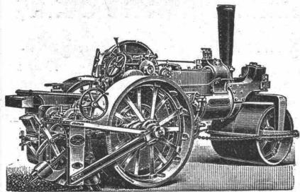
liefert kaufs- und mietweise **DAMPFSTRASSENWALZEN**, **Patent Aveling & Porter**, mit oder ohne mechanischem Strassenauftreiber; in Gebrauch bei einer grössern Anzahl schweiz. Behörden. **Strassenlokomotiven** zur Beförderung leichter und schwerer Lasten.
