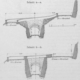
Abb. 10. Gewölbte Strassen-Ueberführung bei Km. 0,71.
