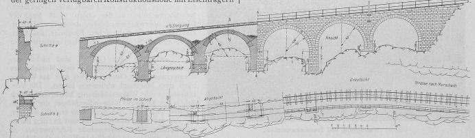
Abb. 7. Lehnenviadukt bei Km. 1,1 bis 1,2. — Grundriss, Ansicht, Längenschnitt und Querschnitte. — Masstab 1:400.
