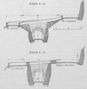
Abb. 10. Gewölbte Strassen-Ueberführung bei Km. 0,71.
