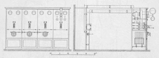
Abb. 9. Die Apparatenanlage. Ansicht und Querschnitt. — Masstab 1:60.
