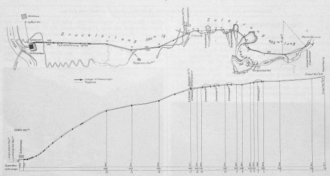
Abb. 3. Lageplan und Längenprofil der Wasserkraftanlage für das Elektrizitätswerk Linthal. — Masstab I: 5000.
