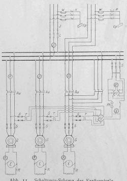
Abb. 11. Schaltungs-Schema der Kraftzentrale.
