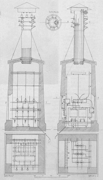
Abb. 14. Transformatorenhäuschen. Schnitte. — Masstab 1:60.
