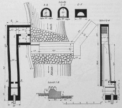
Abb. 4. Die Wasserfassungsanlage. Grundriss und Schnitte. — Masstab 1:300.
