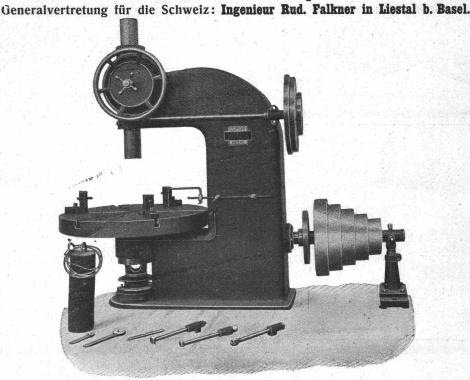
Horizontal-Bohr- und Fräsmaschine mit elektrischem Antrieb.
