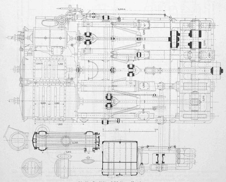
Abb. 6b. Draufsicht und Schnitte. — Masstab 1:40. Liegende Dreifach-Expansionsmaschine von 850 P. S. für das Schleppräderboot «Ruhrort VI» auf dem Rhein. Gebaut von Escher Wyss & Cie. 1903.
