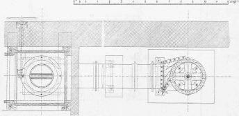
Abb. I. Tangentialrad für Laiblin & Elben in Pfullingen. - I:60. Gebaut von Escher Wyss & Cie. 1847.
