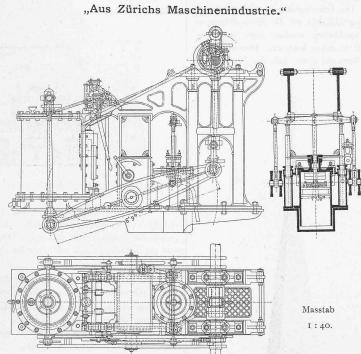
Abb. 7. Vertikale Balancier-Maschine für Dampfboot «Niesen» auf dem Thunersee. Gebaut von Escher Wyss & Cie. 1843.
