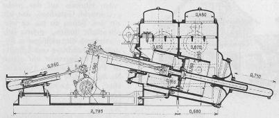
Abb, 6 c, Vertikalschnitt durch den Kondensator der liegenden 850 P. S. Maschine.
