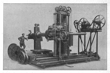
Horizontal-Bohr- und Fräsmaschine mit elektrischem Antrieb.
