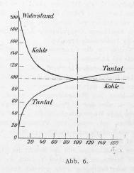
In Abbildung 6 ist die Veränderung des Widerstandes von Tantal und Kohle als Funktion der Lampenspannung graphisch aufgetragen und zwar in der Weise, dass bei einer Strombelastung mit 1,5 Watt pro Hefnerkerze Spannung und Widerstand = 100 gesetzt sind, sodass also für jede prozentuale Aenderung der Spannung die entsprechenden prozentualen Aenderungen der Widerstände ersichtlich sind.
