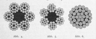
langt wurden, fanden die aus starkem Draht geflochtenen (jede Drahtlage in entgegengesetzter Richtung gewunden) Litzen als *Drahtspiralseile* Eingang. Abbildung 6 gibt die Darstellung eines 6+12+18=36 drähtigen Seiles dieser Art, das statt der Hanfseele einen Kerndraht hat. Sollen besonders biegsame, vieldrähtige Seile erhalten werden, so
