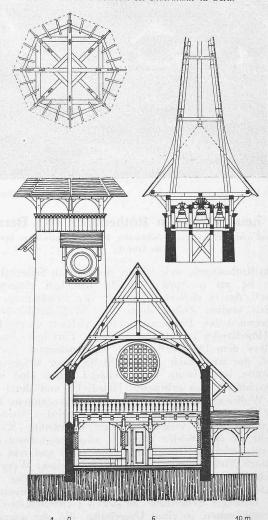
Abb. 3. Querschnitt durch das Kirchenschiff. — Schnitte durch den Turm. — Masstab 1:200.
