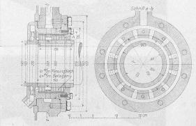
Abb. 8. Die Stopfbüchse. - Masstab 1:10.
