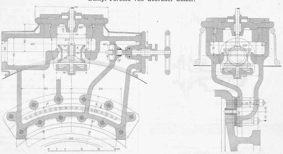
Abb. 9 und 10. Regulierungsdetails. — Masstab 1:10.
