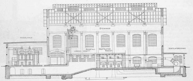
Abb. 4. Längenschnitt durch Kesselhaus, Ofenhaus und Ventilatorenhaus. — Masstab 1:300.
