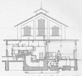
Abb. 6. Längenschnitt durch das Kessel- und Maschinenhaus. — 1:300.
