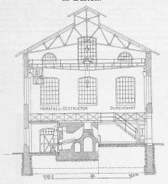
Abb. 5. Querschnitt durch das Ofenhaus. — 1:300.
