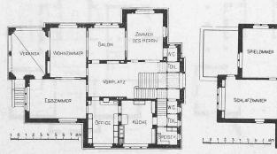
Abb. 19. Grundrisse vom Erdgeschoss und I. Obergeschoss der Villa E. Huber-Stockar in Zürich V. — Masstab 1:400.
