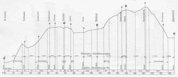
Abb. 4. Generelles Längenprofil. — Masstab I: 100 000 für die Längen, 1: 4000 für die Höhen.
