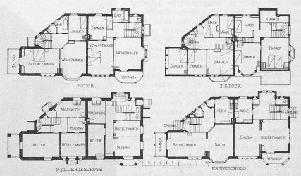
Abb. 7. Doppelvilla an der Klosbachstrasse in Zürich (Nr. 146, 148). Grundrisse. — Masstab 1:400.
