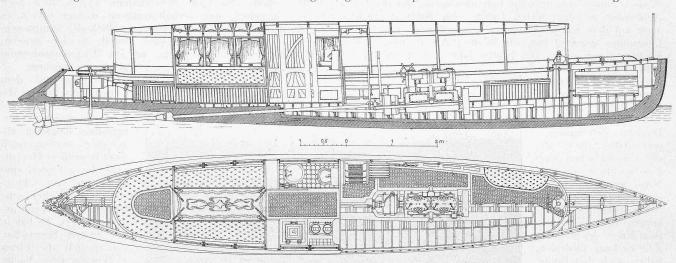
Abb. 3. Boot «Minnehaha», gebaut von F. Treichler & Cie. in Bendlikon bei Zürich. Längenschnitt und Draufsicht. — Masstab 1:75.
