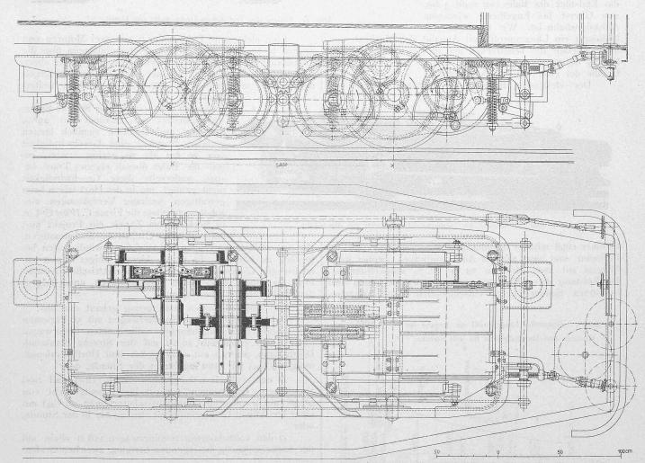
Abb. 6. Drehgestell mit dem von C. Wüst & Cie. in Seebach eingebauten elektrischen Antrieb, — Ansicht, Grundriss und Schnitt. — Masstab I : 25.
