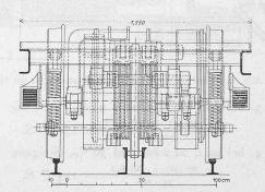
Abb. 8. Drehgestell. Schnitt durch die Mitte. - 1:25.
