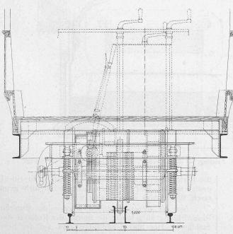
Abb. 7. Drchgestell. Schnitt durch die Plattform. — 1:25.
