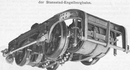
Abb. 4. Untersicht des Drehgestells mit dem elektrischen Antrieb, von hinten.
