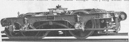
Abb. 3. Ansicht des Treibachsen-Drehgestells von der Seite.
