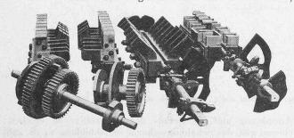
Abb. 13. Detailstücke zum Kontroller.
