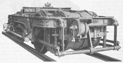
Abb. 2. Ansicht des Treibachsen-Drehgestells von hinten.
