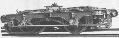
Abb. 3. Ansicht des Treibachsen-Drehgestells von der Seite.
