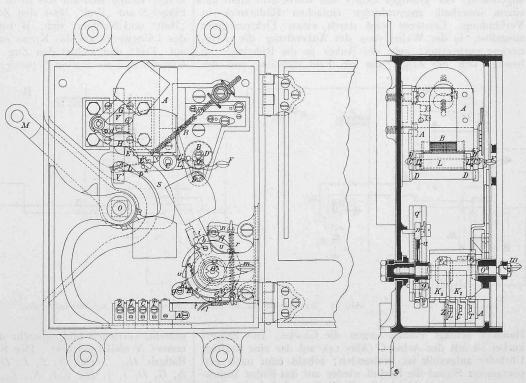
Abb. 11 u. 12. Apparatenschrank des Blocksystems der P. L. M. — Innenansicht und Vertikalschnitt. — Masstab 1:4.
