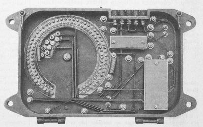
Abb. 3. Reguliervorrichtung zum «System Aichele» (Brown, Boveri & Cie.). Ansicht des Kastens mit den Apparaten bei herabgelasssenem hinterem Deckel.
