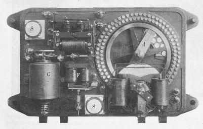
Abb. 2. Reguliervorrichtung zum «System Aichele» (Brown, Boveri & Cie.). Ansicht des Kastens mit den Apparaten bei herabgelassenem vorderem Deckel.
