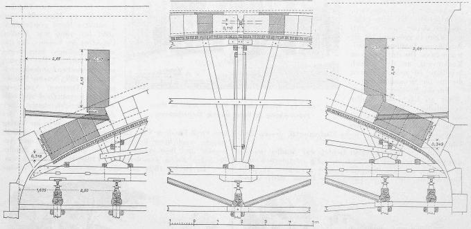
Abb. 4. Detail des linken Bogens. - Masstab 1:100.
