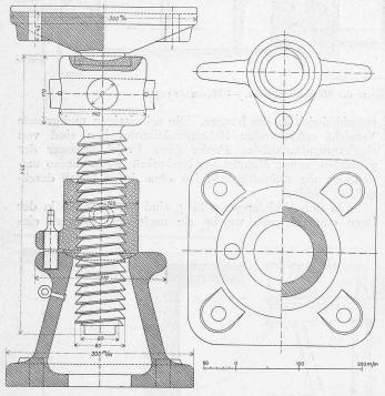
Abb. 6. Senkschraube für das Lehrgerüst. — Masstab 1:6.
