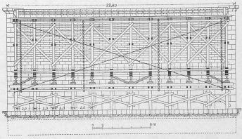
Abb. 7. Querschnitt im Scheitel des Bogens. — Masstab 1:350.
