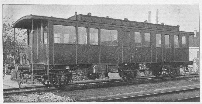
Abb. 1. Personenwagen der S. B. B. mit Elektrischer Zugsbeleuchtungs-Einrichtung «System Aichele».
