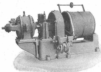
mit automatisch-elektrischer Druckknopfsteuerung
