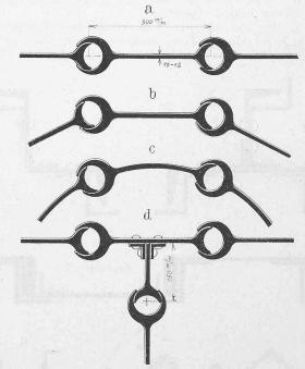
Abb. 11. Profil «Behrend» der «United States Steel Piling Co.»
