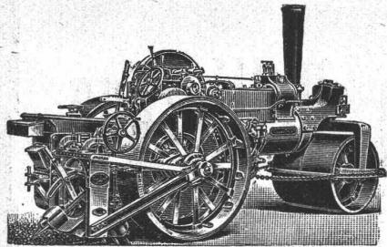
liefert kauf- und mietweise **DAMPFSTRASSENWALZEN**, Patent Aveling & Porter, mit oder ohne mechanischem Strassenauflöser; in Gebrauch bei einer grösseren Anzahl schweiz. Behörden. **Strassenlokomotiven** zur Beförderung leichter und schwerer Lasten.
