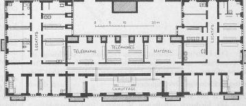
Grundriss vom Untergeschoss. - Masstab 1:800.
