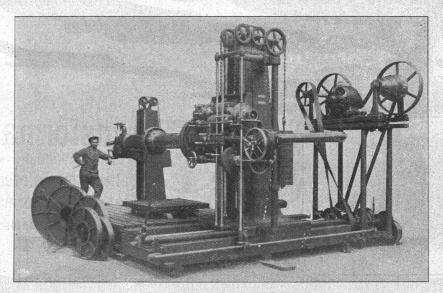
Horizontal-Bohr- und Fräsmaschine mit elektrischem Antrieb.
