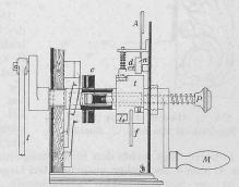
Abb. 8. Vertikalschnitte des Blocksignalapparates. — Masstab 1:10.
