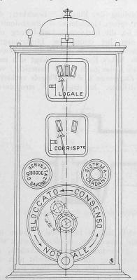
Abb. 7. Ansicht des Blocksignalapparates.
