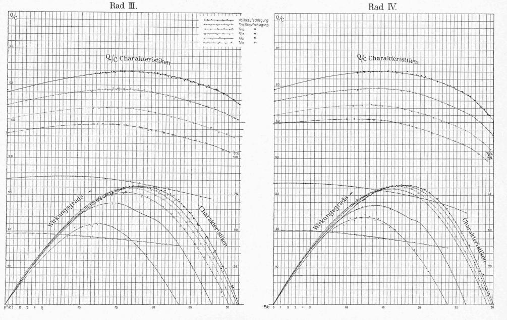
Abb. 21. Hauptcharakteristiken für Rad III und IV.
