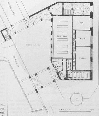
Grundriss vom Erdgeschoss. - Masstab 1:500.
