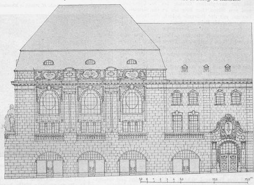
Ansicht der Fassade an der Marktgasse. — Masstab 1: 250.
